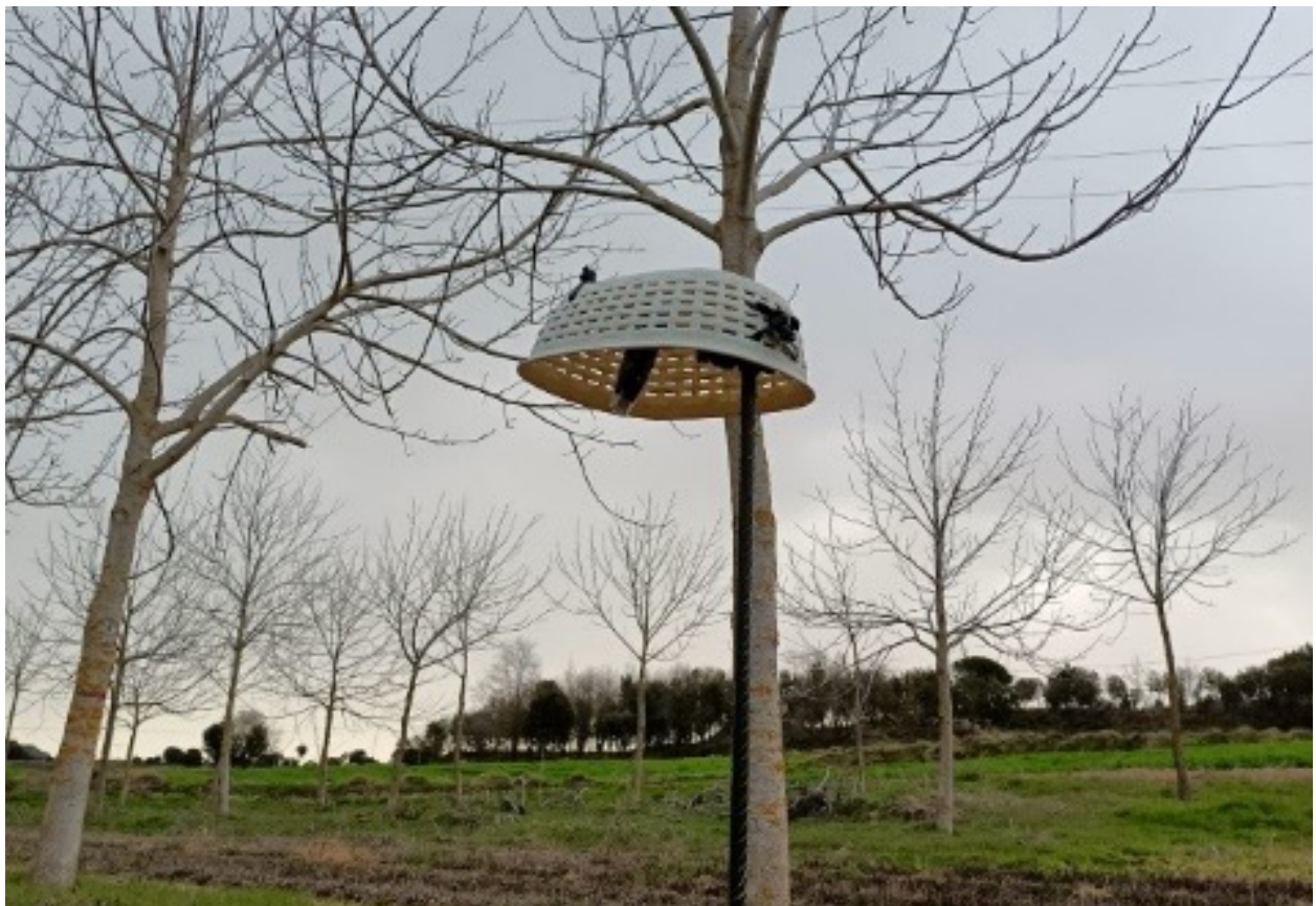
Station de surveillance équipée de capteurs de luminosité, d'humidité et de température ambiante et du sol sur une parcelle sylvicole (Barcelone, Espagne).
