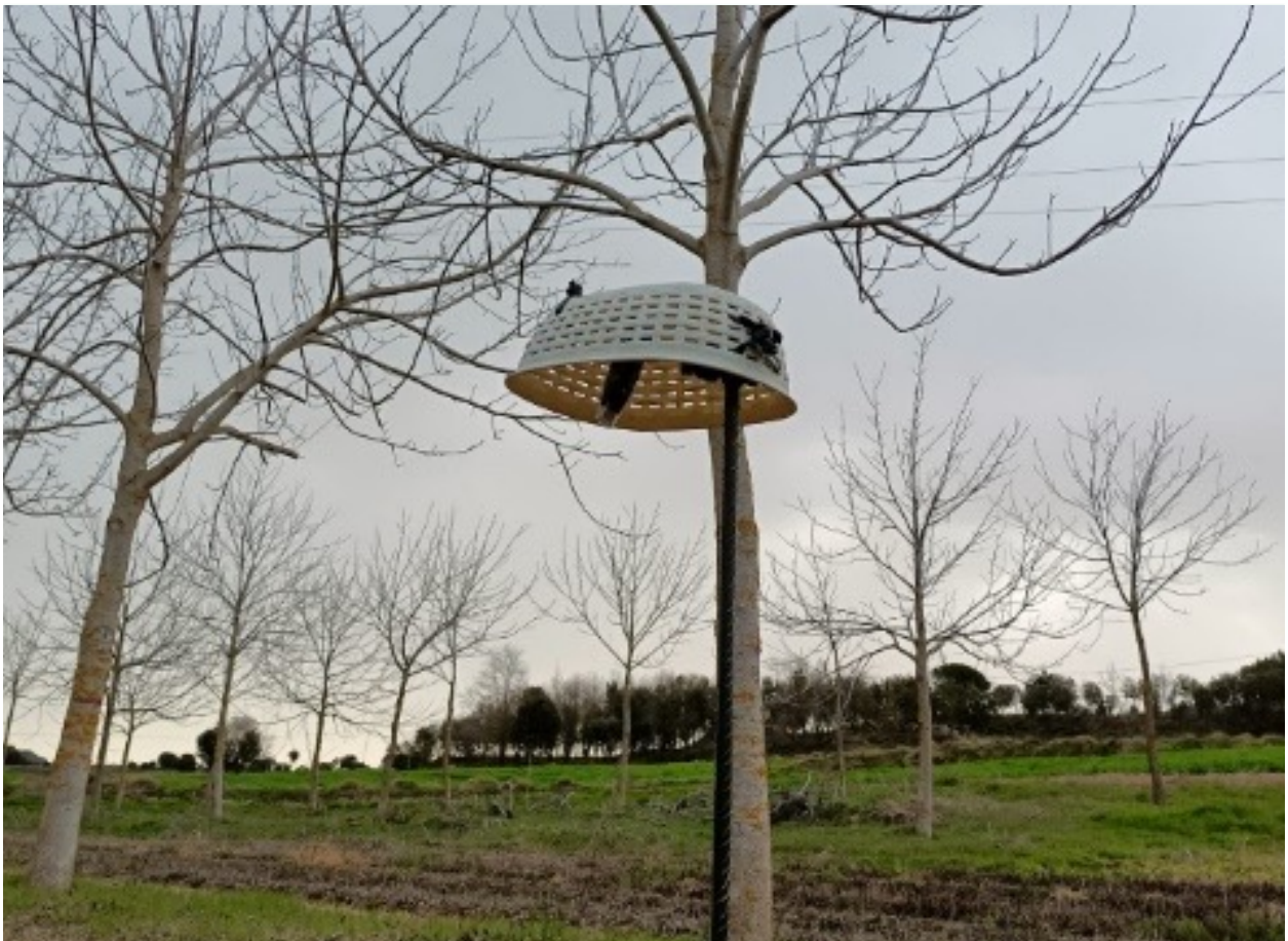
Estación de seguimiento con sensores de luz y de humedad y temperatura ambiental y del suelo en una parcela silvoarable (Sagàs-Barcelona).
