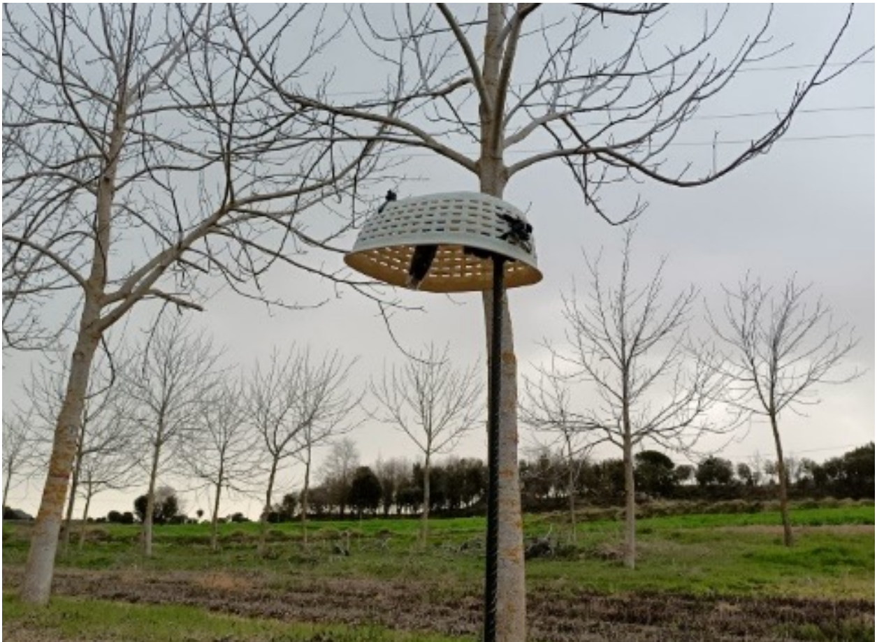
Estació de monitoratge amb sensors de llum, humitat, temperatura ambiental i del sòl en una parcel·la silvoarable (Sagàs, Barcelona).
